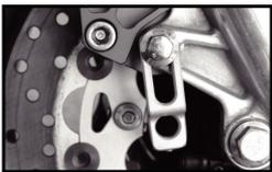
Installieren Sie die Sensorhalterung vom S-Typ.
