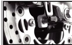
Installieren Sie den Geschwindigkeitssensor an der Halterung.
