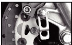
Installieren Sie die Sensorhalterung vom S-Typ.
